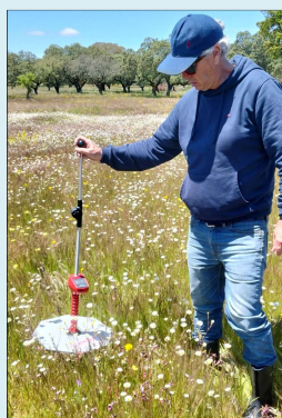
“Rasing Plate Meter” Altura e produtividade da pastagem
