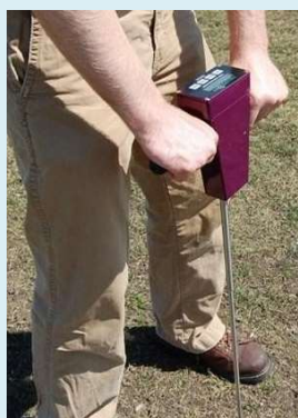
“Cone Penetrómetro Electrónico” Compactação do solo
