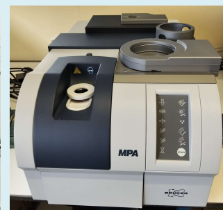
Espectrómetro NIR MPA da Bruker
